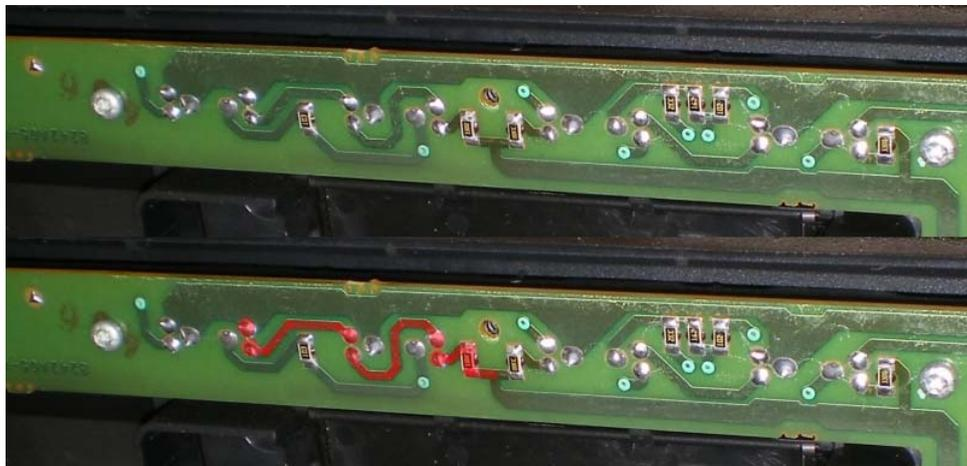
C'est bien la résistance qui est la coupable. Ses soudures sont fatiguées et ne font plus contact, il m'a donc suffi de la ressouder et tout fonctionne de nouveau.
