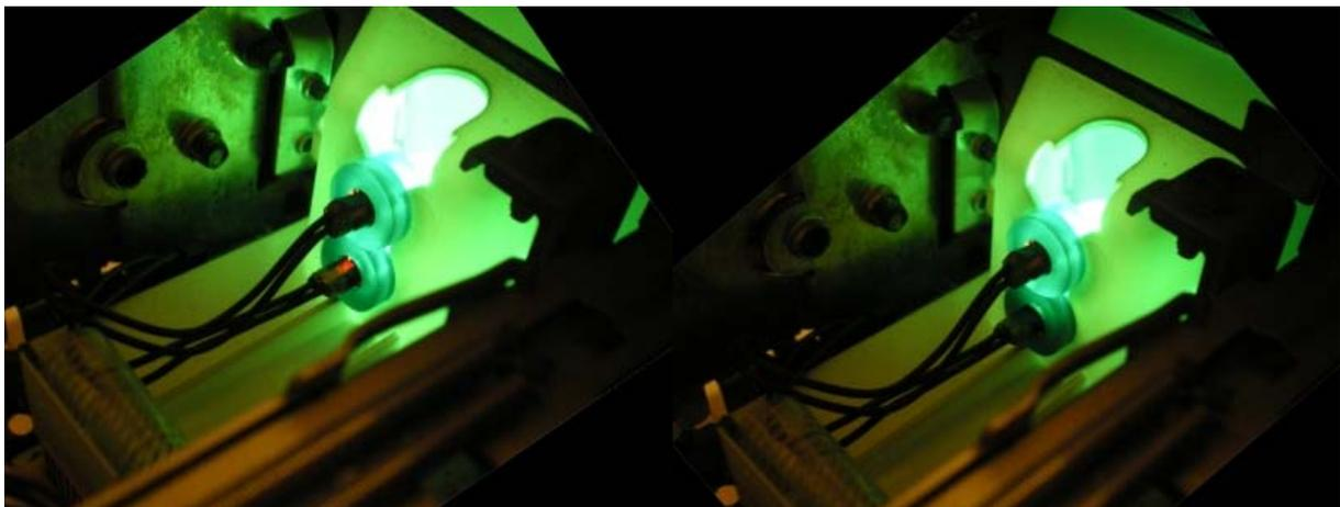
Chaque ampoule est une simple luciole (petite lampe à incandescence) recouverte d'un petit capuchon vert.
